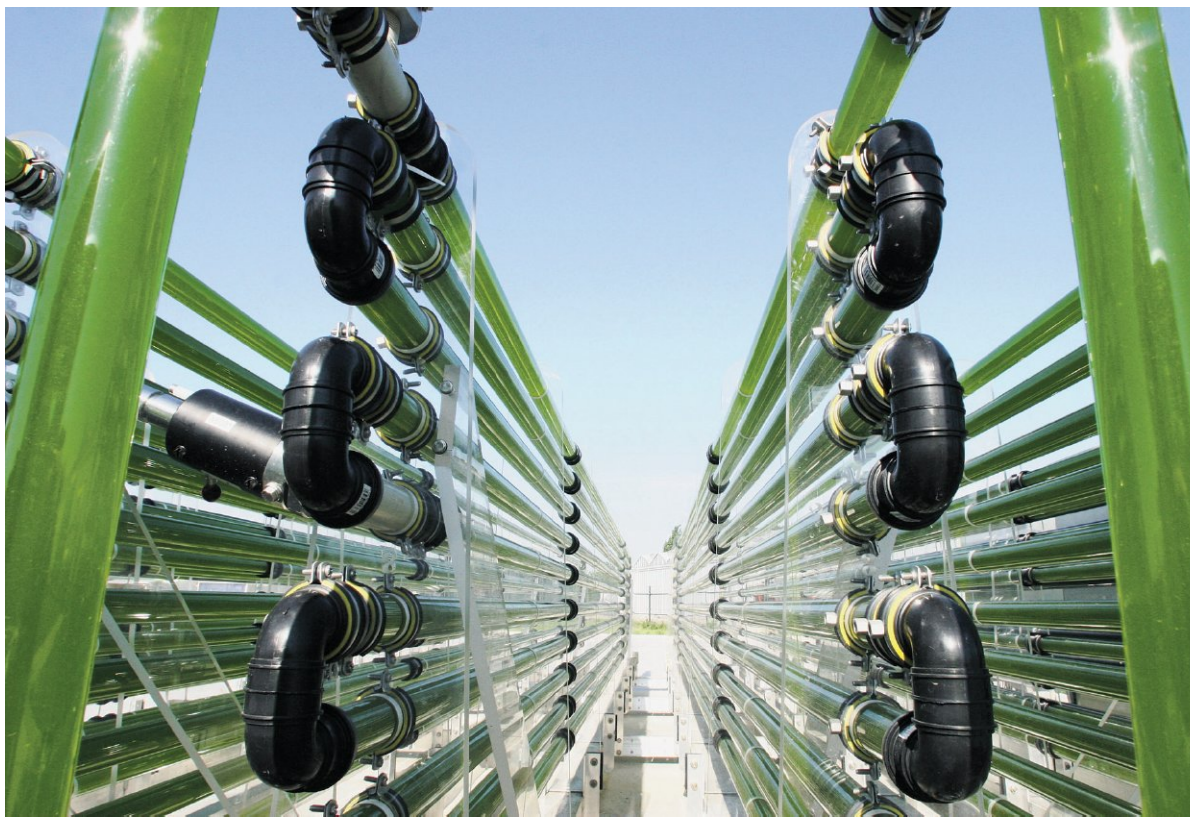
In deze buizenreactoren worden algen gekweekt. Algen stromen in 5 minuten door het circuit. Foto Wageningen UR
